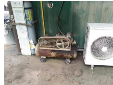
อุปกรณ์ปั๊มลมอัดโนมัต มีการดัดแปลงจนที่ยังไม่ผ่านมาตรฐานที่กำหนด
