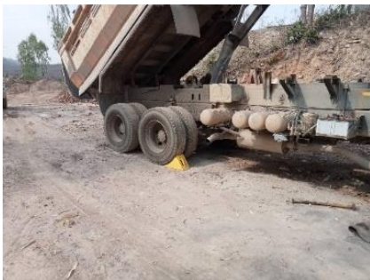
การซ่อมแซมเครื่องจักรประเภทรถบรรทุก ได้มีการคัมล้อรถและกระเบดัมทุกครั้ง
